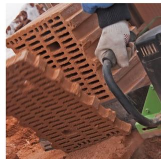
Sega elettrica a doppia lama per il taglio a secco di Poroton, mattoni forati, Gasbeton, cemento cellulare.
