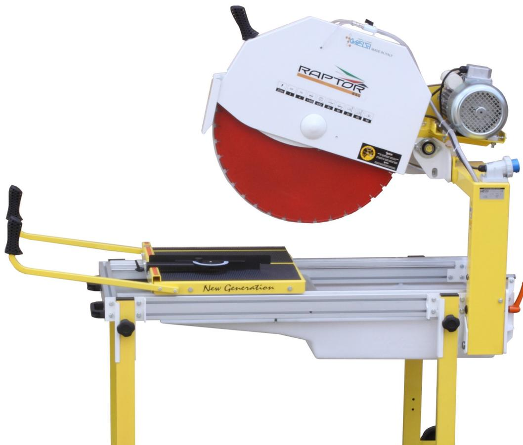
**Idéale pour la coupe des briques, du Poroton et des autres matériaux de construction — jusqu'à 26 cm en une passe.**
