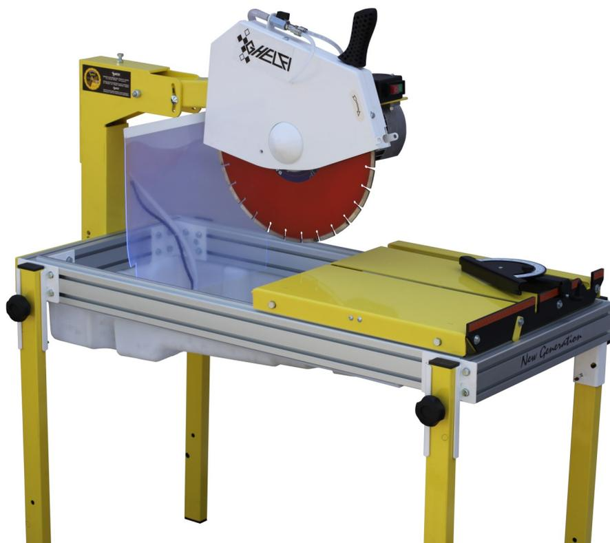
**Idéale pour la coupe des briques et des autres matériaux de construction — jusqu'à 14 cm en une passe.**
